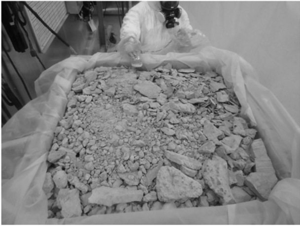
図 3.4.2-1 JRR-4 廃棄物のコンクリート廃棄物
