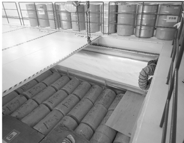
図 3.6.1-4 優先度区分 A のピット内の保管体の保管状況
